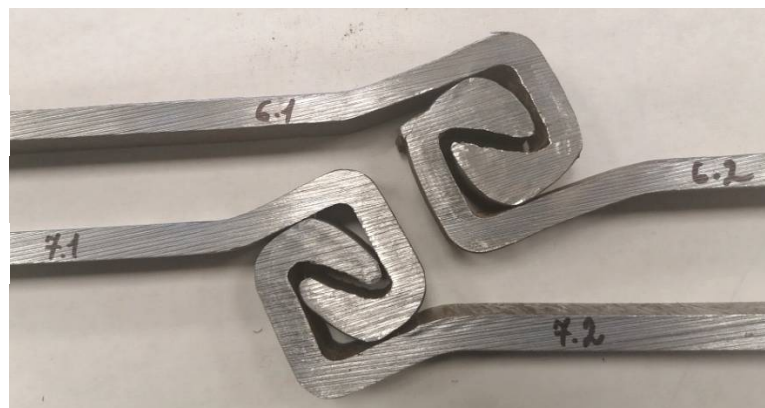
Рисунок 6.1– Внешний вид замков до испытания на растяжение
