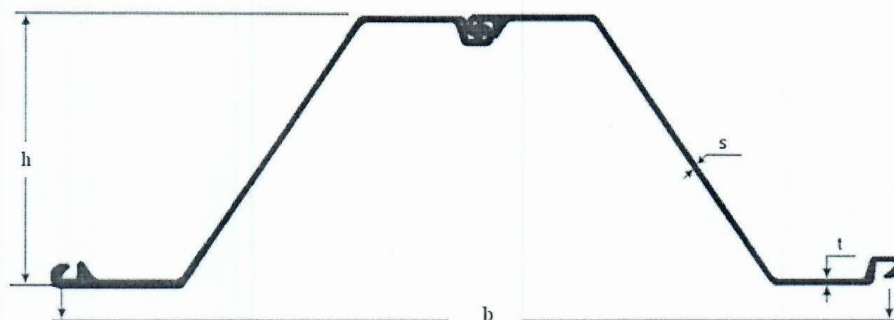
Рисунок 1.1 - Профиль Z-образного шпунта
